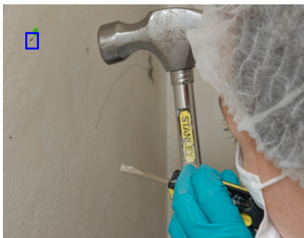
Figura 14: muestreo de muro para corte estratigráfico. El encuadre azul señala el tamaño de la muestra extraída.
