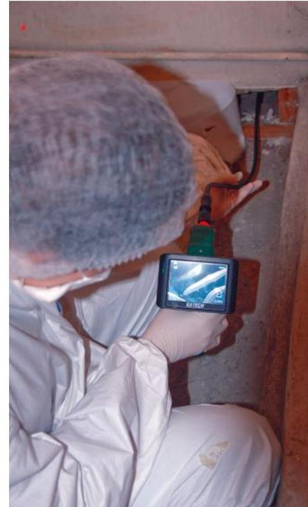
↑ El desmantelamiento del guardapolvo del muro sur del recinto dejó al descubierto un orificio que permitió observar el espacio tras la plancha de fibrocemento con un visor flexible, detectándose hojas de periódico que posibilitarían estimar la fecha de cierre de dicho lugar. Fotografía: M. Roubillard, 2012. Archivo CNCR.
